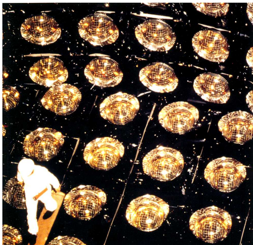
Obr. 9.5: Vyprázdněná nádrž obřího neutrinového detektoru Superkamioka, se stěnami pokrytými výkonnými fotonásobiči.
