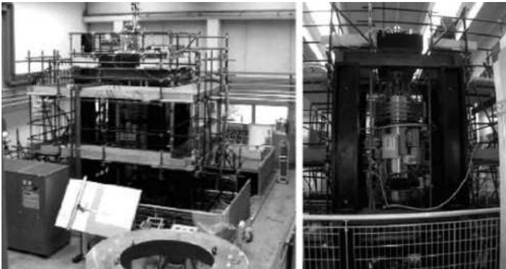
Obr. 8.7: PVLAS: Nalevo celkový pohled na experiment, napravo je žulová věž o výšce 7 metrů, ve které je umístěn kryostat (chladicí zařízení) a v horní části optická lavice.
